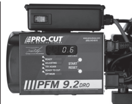
L'ordinateur a réglé le voile latéral à 0.0006 po et est prêt à réuser.
